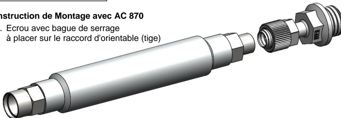
2. Bague de serrage avec aide au montage AC 870 jusqu'à la butée. Ainsi, la bague de serrage est correctement positionné sur la tige
